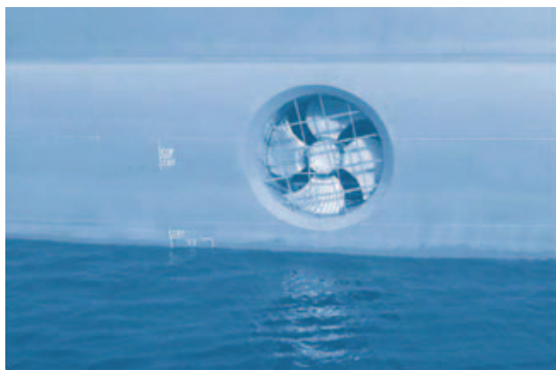
Figura 15: Hélice de maniobra en el casco de un buque
